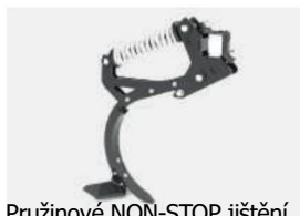
Pružinové NON-STOP jištění s dvojitou pružinou- 600 kg
