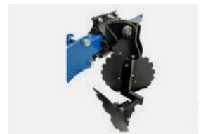
Řada urovňovacích disků na gumovém+kolíkovém jišťení-STANDARD
